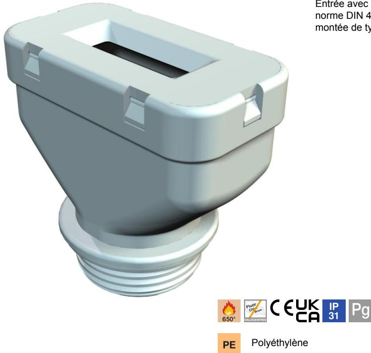
Entrée avec raccord d'étranglement pour câbles plats, avec filetage PG selon la norme DIN 40430, indice de protection IP 31, avec bague d'étanchéité pré-montée de type 107/F.
