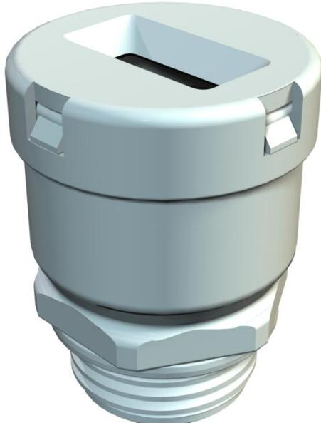
Entrée avec raccord d'étranglement pour câbles plats, avec filetage métrique selon la norme CEI 432, indice de protection IP 31, avec bague d'étanchéité pré-montée de type 107/F.
