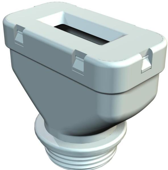
Entrée avec raccord d'étranglement pour câbles plats, avec filetage métrique selon la norme CEI 432. Indice de protection IP 31, avec bague d'étanchéité pré-montée de type 107/F.
