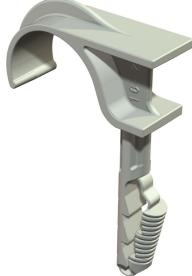
Les colliers emboîtables sont destinés à la pose de câbles et de tubes sur les murs et plafonds ainsi qu'à la pose de tubes flexibles sur les supports en béton et en plâtre. Les colliers emboîtables simples remplacent les clips de fixation à clou dans le béton et le béton cellulaire. L'avantage des colliers emboîtables est qu'ils doivent simplement être emboîtés dans le trou de montage. L'utilisation de chevilles et de vis devient alors inutile.
