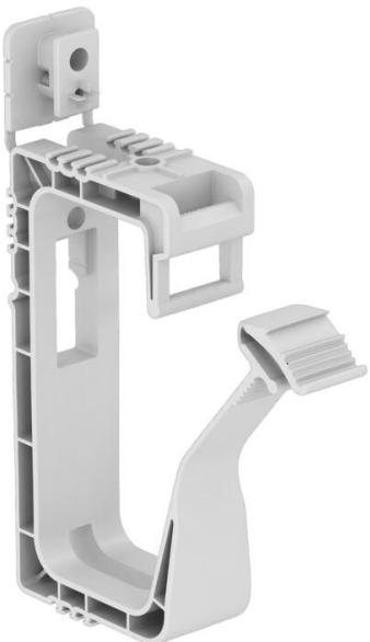
Passe-câbles avec fixation intégrée, conçu pour accueillir jusqu'à 40 câbles NYM 3 x 1,5 mm<sup>2</sup>, en montage mural ou plafond. Fixation par cheville à frapper ou cheville à expansion. Également compatible avec les appareils de pose à gaz ou à batterie des marques Bosch, Fischer et Spit (diamètre intérieur du nez : 7 mm). Trou de fixation Ø 6 mm. Espacement de fixation conseillé en charge maximale : 2,5 à 4 m, sous réserve des normes nationales applicables.
