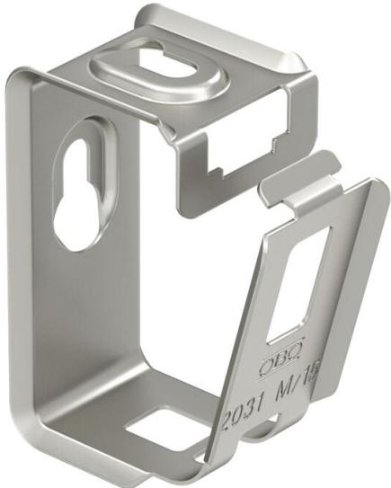
Passe-câbles métalliques pour une résistance mécanique élevée, même en cas d'incendie. Approprié pour un montage sécurisé au-dessus de plafonds coupe-feu. Autorisé également comme variante spécifique pour la sécurité de fonctionnement électrique selon la norme DIN 4102 partie 12. Pour montage au mur et au plafond. Fermeture ouvrable sans outil.
