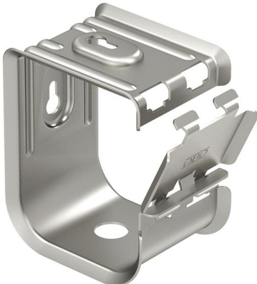
Passe-câbles métalliques pour une résistance mécanique élevée, même en cas d'incendie. Approprié pour un montage sécurisé au-dessus de plafonds coupe-feu. Autorisé également comme variante spécifique pour la sécurité de fonctionnement électrique selon la norme DIN 4102 partie 12. Pour montage au mur et au plafond. Fermeture ouvrable sans outil.
