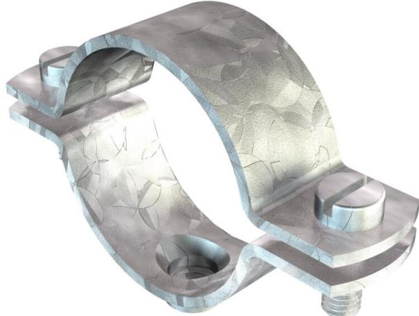
A visser sur filetage M8. La taille 27 FT convient à M25. La taille 42,5 FT convient à M40. La taille 48,5 FT convient à M50. La taille 60 FT convient à M63
