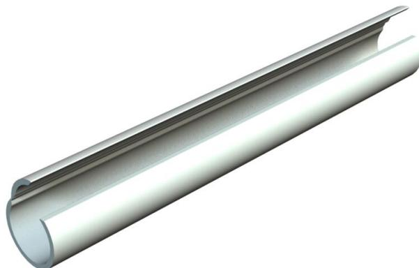
Tube ouvert Quick-Pipe en plastique pour pose en saillie de câbles et conduites, en intérieur et extérieur protégé. Montage au mur et au plafond avec colliers Quick, Star-Quick et Multi-Quick. Fermeture et ouverture sans outils par rotation dans le collier. Utilisation possible à des températures comprises entre -25 °C et +60 °C.
