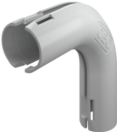
Pièce préformée pour tubes d'installations électriques en matière plastique pour créer des coude à 90°. Convient aux tubes Quick-Pipe ou tubes ondulés. Fermeture et ouverture sans outils. Utilisation possible à des températures comprises entre -25 °C et +60 °C.
