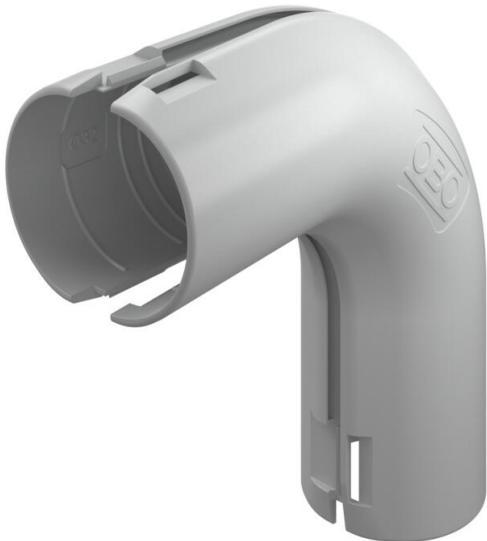
Pièce préformée pour tubes d'installations électriques en matière plastique pour créer des coudes à 90°. Convient aux tubes Quick-Pipe ou tubes ondulés. Fermeture et ouverture sans outils. Utilisation possible à des températures comprises entre -25 °C et +60 °C.
