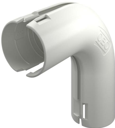
Le système tubulaire OBO Quick Pipe en matière plastique se compose comme une goulotte dans laquel peuvent être posés des câbles et des conduits. En tournant le Quick Pipe OBO dans le collier OBO Quick, il se ferme et protège les câbles ou les conduits comme un tube fermé. Les pièces de forme tels que les coudes à 90°, les tés et les manchons de raccordement constituent les accessoires de la gamme.
