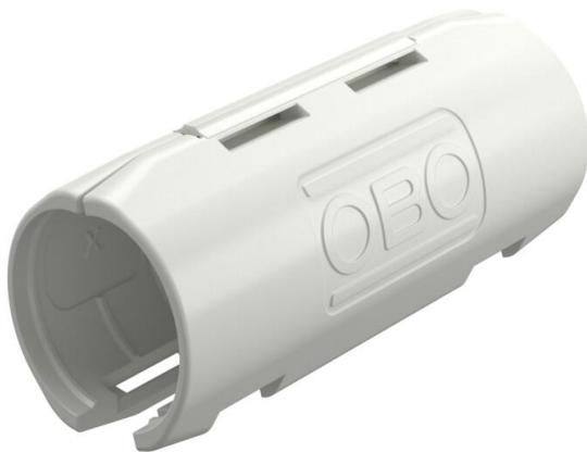
Le système tubulaire OBO Quick Pipe en matière plastique se compose comme une goulotte dans laquel peuvent être posés des câbles et des conduits. En tournant le Quick Pipe OBO dans le collier OBO Quick, il se ferme et protège les câbles ou les conduits comme un tube fermé. Les pièces de forme tels que les coudes à 90°, les tés et les manchons de raccordement constituent les accessoires de la gamme.
