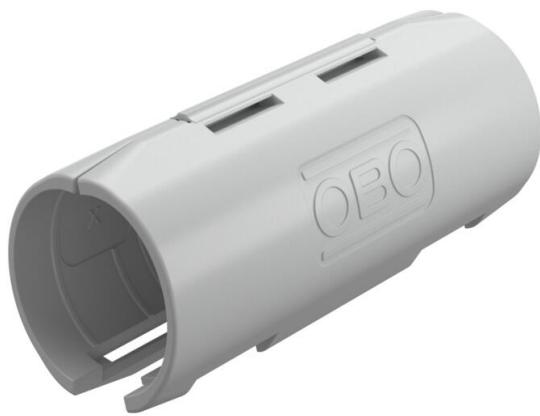
Manchon de raccordement pour tubes d'installation électrique en matière plastique pour créer des éclissages. Convient aux tubes Quick-Pipe ou tubes ondulés. Fermeture et ouverture sans outils. Utilisation possible à des températures comprises entre -25 °C et +60 °C.
