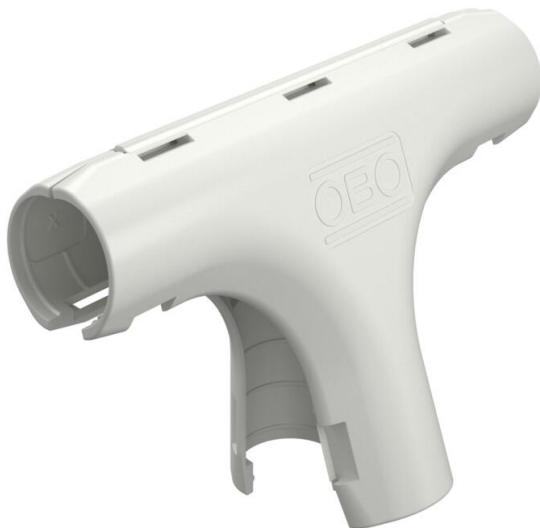
Le système tubulaire OBO Quick Pipe en matière plastique se compose comme une goulotte dans laquel peuvent être posés des câbles et des conduits. En tournant le Quick Pipe OBO dans le collier OBO Quick, il se ferme et protège les câbles ou les conduits comme un tube fermé. Les pièces de forme tels que les coudes à 90°, les té et les manchons de raccordement constituent les accessoires de la gamme.
