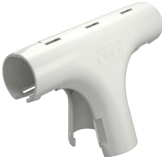
Le système tubulaire OBO Quick Pipe en matière plastique se compose comme une goulotte dans laquel peuvent être posés des câbles et des conduits. En tournant le Quick Pipe OBO dans le collier OBO Quick, il se ferme et protège les câbles ou les conduits comme un tube fermé. Les pièces de forme tels que les coudes à 90°, les té et les manchons de raccordement constituent les accessoires de la gamme.
