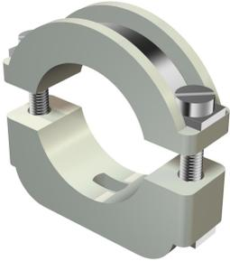
Colliers isolants pour paratonnerre: collier en matière plastique avec garniture métallique, convient par conséquent aussi pour les charges lourdes; pièces métalliques en acier galvanisé.
