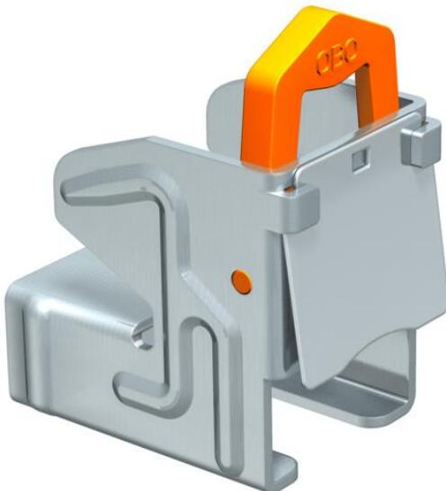
Pince de fixation automatique sans vis avec revêtement anticorrosion, avec ressort d'arrêt convenant aux rails profilés des types CML3518 et CMS3518. Pour la fixation rapide sur les profilés en acier lors du montage de chemins de câbles, de brides de fixation BBS et de suspensions de luminaires, etc. Un système complet se compose de
