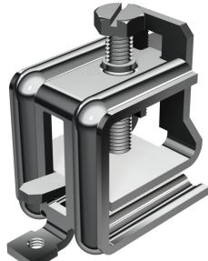
Pour la fixation rapide sur structure en acier de chemins de câbles, de brides de fixation BBS et de suspensions de luminaires, etc. Un système complet se compose de 2 pinces de fixation et d'un élément de profilé en C d'une longueur quelconque et de 2 embouts de protection.
