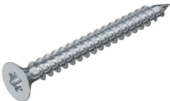
Acier trempé et galvanisé, revêtement Hostaflon. Tête fraisée avec embout en T (six pans creux), de Ø 3 mm T10, Ø 3,5 mm T15, Ø 4 et 4,5 mm T20, Ø 5 mm T25.
