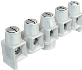
Bornes en laiton nickelé, vis en acier, galvanisées (passivation transparente), section nominale 0,8 ÷ 2,5 mm<sup>2</sup>, tension nominale 660 V, à 5 pôles, avec bornes à douilles, sections de raccordement maximales par point de connexion : 4 x 2,5 mm<sup>2</sup>, 5 x 1,5 mm<sup>2</sup> ou 6 x 1 mm<sup>2</sup>, les pôles superflus peuvent être séparés et être utilisés comme une borne individuelle.
