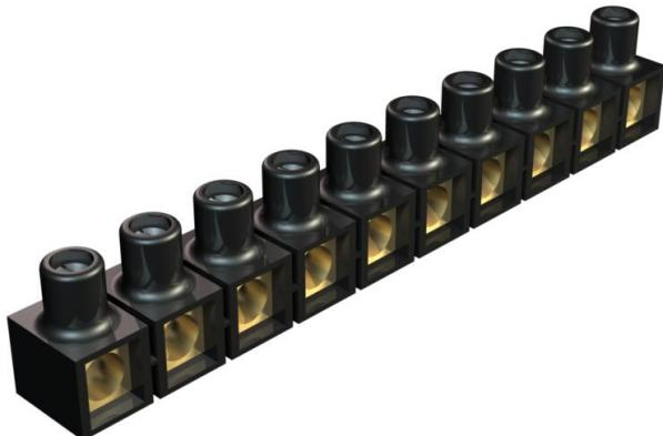
Bornes en laiton, vis en acier, galvanisées (passivation transparentes), bornier à 10 pôles composé de bornes individuelles séparables, ouvert de chaque côté.
