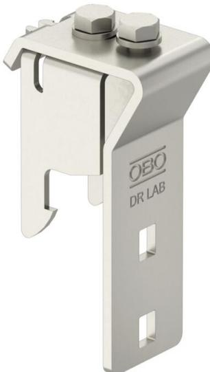
Écarteur pour montage décalé de couvercles sur des chemins de câbles longue portée et des échelles à câbles longue portée. Hauteur d'écart 35 mm, acier inoxydable 1.4301.
