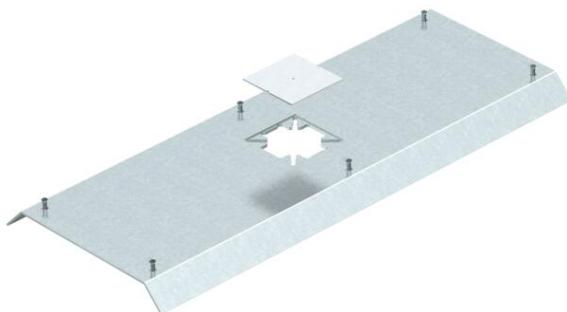
Couvercle pour conduit de dérivation en saillie AIKA/U pour le montage d'un Telitank. Le couvercle du conduit est fermement vissé sur les profilés latéraux Al du socle du conduit. Le chanfrein du couvercle dépasse du socle du conduit selon un angle de 45°.
