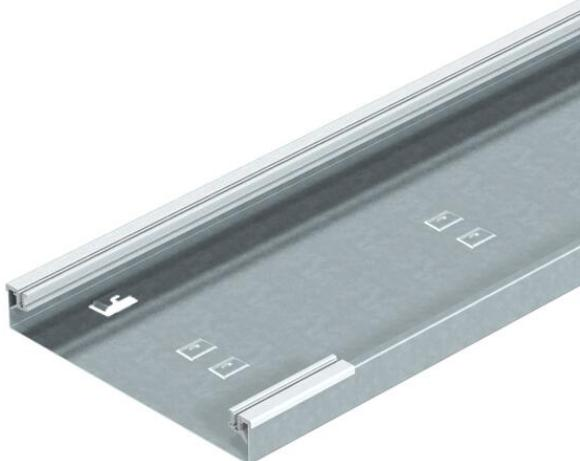
Base de la dérivation du conduit d'installation sous chape pour couvercles/couvercles de montage chanfreinés des deux côtés, pour montage libre sur le plancher, avec profils latéraux en aluminium enfichables pour accrochage et fixation des couvercles. Hauteur de conduit compatible pour la réalisation de modules Telitank.
