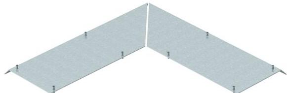
Couvercle en 2 parties pour recouvrir l'angle extérieur d'un conduit sur sol, compatible avec les socles de conduit AIK/U, livrée 10 vis de fixation. Le couvercle de conduit est fermement vissé sur les profilés latéraux de la partie inférieure du conduit. Le chanfrein du couvercle dépasse du socle du conduit selon un angle de 45°.
