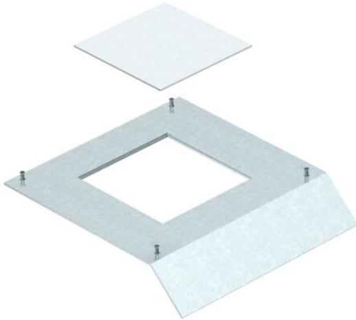
Couvercle pour socle de conduit AIK/U pour le montage d'un boîtier de sol de taille nominale 4 ; ouverture de montage fermée par un obturateur en alu de 2 mm. Le couvercle de conduit est fermement vissé sur les profilés latéraux de la partie inférieure du conduit. Le chanfrein du couvercle dépasse du socle du conduit selon un angle de 45°.
