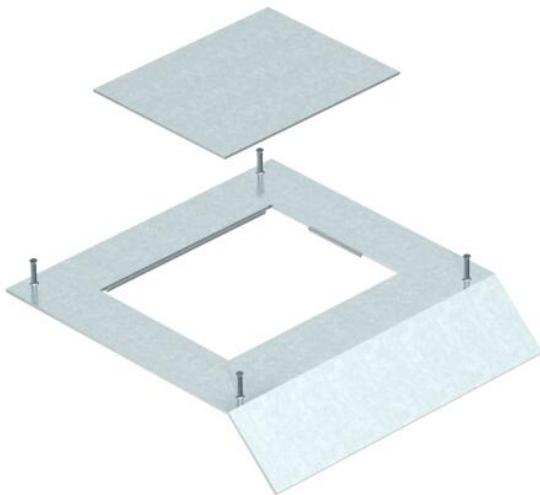
Couvercle pour socle de conduit AIK/U pour le montage d'un boîtier de sol de taille nominale 6 ; ouverture de montage fermée par un obturateur en alu de 2 mm. Le couvercle de conduit est fermement vissé sur les profilés latéraux de la partie inférieure du conduit. Le chanfrein du couvercle dépasse du socle du conduit selon un angle de 45°.
