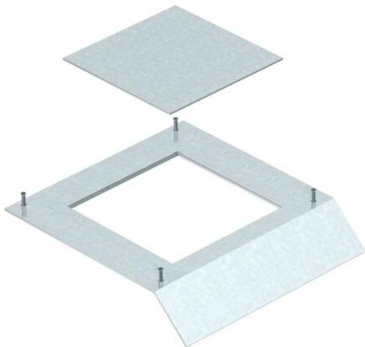
Couvercle pour socle de conduit AIK/U pour le montage d'un boîtier de sol de taille nominale 9 ; ouverture de montage fermée par un obturateur en alu de 2 mm. Le couvercle de conduit est fermement vissé sur les profilés latéraux de la partie inférieure du conduit. Le chanfrein du couvercle dépasse du socle du conduit selon un angle de 45°.
