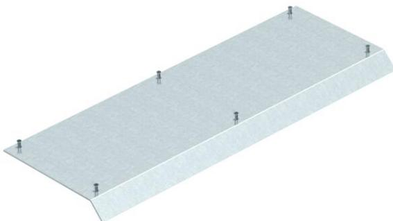
Couvercle pour le conduit d'installation en saillie AIK, compatible avec les socles de conduit AIK/U. Le couvercle de conduit est vissé dans les profilés latéraux AI du socle. Le chanfrein du couvercle dépasse du socle du conduit selon un angle de 45°.
