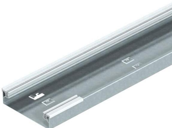
Socle de conduit d'installation en saillie, à 1 compartiment pour couvercle de montage, chanfreinée d'un seul côté, avec profilés latéraux en aluminium emboîtables pour accrochage et fixation des couvercles, plaque de sol avec pattes de fixation pour 2 séparateurs max. emboîtables par enclenchement automatique et empreinte pour équerre de raccordement à la terre. Hauteur de conduit compatible pour la réalisation de modules Telitank.
