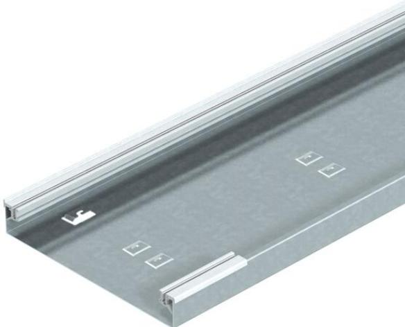
Socle de conduit d'installation en saillie, à 1 compartiment pour couvercle/couvercle de montage, chanfreinée d'un seul côté, avec profilés latéraux en aluminium emboîtables pour accrochage et fixation des couvercles, plaque de sol avec pattes de fixation pour 2 séparateurs max. emboîtables par enclenchement automatique et empreinte pour équerre de raccordement à la terre. Hauteur de conduit compatible pour la réalisation de modules Telitank.
