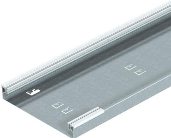
Socle de conduit d'installation en saillie, à 1 compartiment pour couvercle/couvercle de montage, chanfreinée d'un seul côté, avec profilés latéraux en aluminium emboîtables pour accrochage et fixation des couvercles, plaque de sol avec pattes de fixation pour 2 séparateurs max. emboîtables par enclenchement automatique et empreinte pour équerre de raccordement à la terre. Hauteur de goutte adaptée au montage de boîtiers de sol de taille nominale 2.
