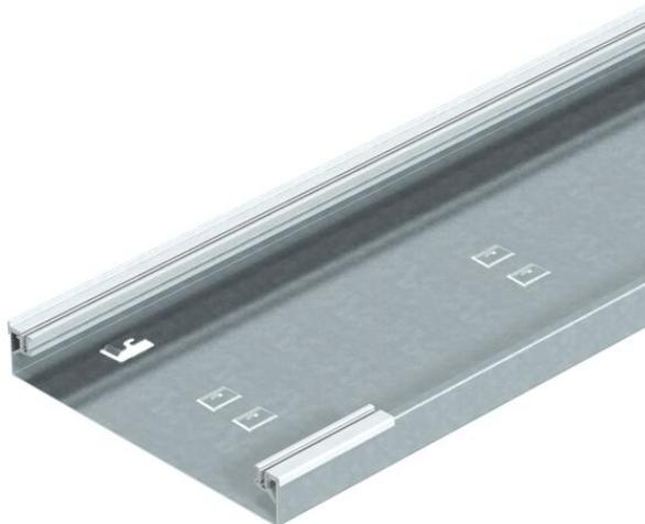
Socle de conduit d'installation en saillie, à 1 compartiment pour couvercle de montage, chanfreinée d'un seul côté, avec profilés latéraux en aluminium emboîtables pour accrochage et fixation des couvercles, plaque de sol avec pattes de fixation pour 2 séparateurs max. emboîtables par enclenchement automatique et empreinte pour équerre de raccordement à la terre. Hauteur de conduit adaptée au montage en saillie de Telitank ou pour le montage de boîtier de sol de taille nominale 4, 6, 9.
