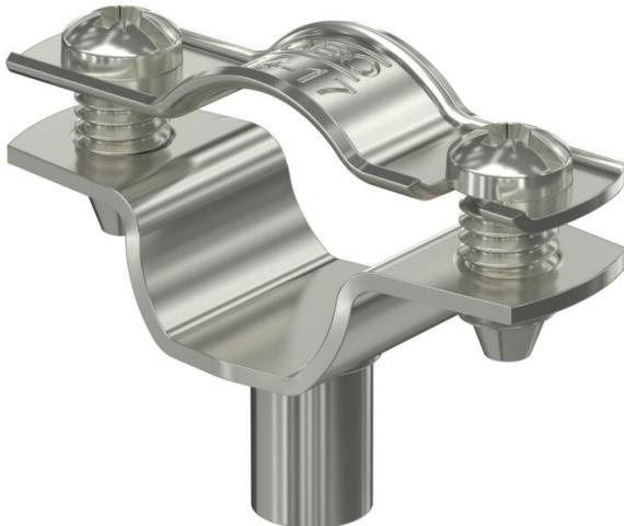
Collier d'écartement pour le montage de tubes et câbles au mur, au plafond et au sol. Avec couvercle autobloquant. Fixation par l'embase avec filetage intérieur. Autorisé pour la maintenance conformément à la norme DIN 4102, partie 12, classes de maintenance E 30 jusqu'à E 90.
