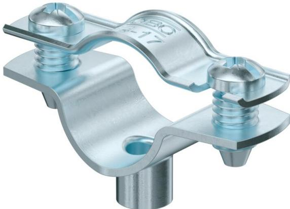
Collier d'écartement pour le montage de tubes et câbles au mur, au plafond et au sol. Avec couvercle autobloquant. Fixation par l'embase avec filetage intérieur. Autorisé pour la maintenance conformément à la norme DIN 4102, partie 12, classes de maintenance E 30 jusqu'à E 90.
