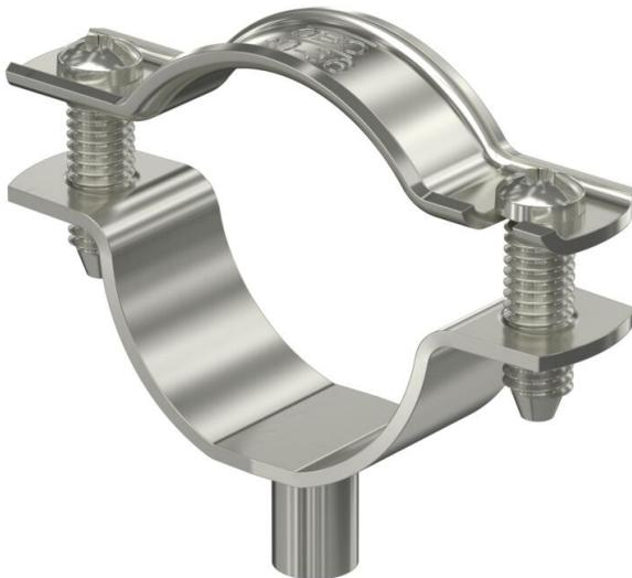
Collier d'écartement pour le montage de tubes et câbles au mur, au plafond et au sol. Avec partie supérieure autobloquante. Fixation par l'embase avec filetage intérieur. Surfaces G et FT à partir de la taille 20 des colliers convenant au montage avec cloueur ou pistolet de scellement.
