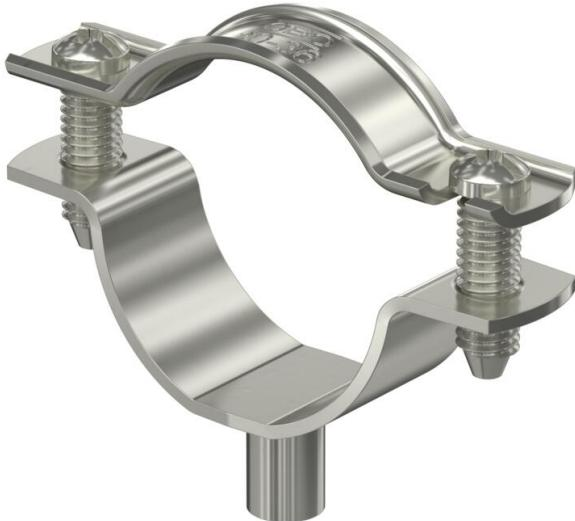
Collier d'écartement pour le montage de tubes et câbles au mur, au plafond et au sol. Avec couvercle autobloquant. Fixation par l'embase avec filetage intérieur. Autorisé pour la maintenance conformément à la norme DIN 4102, partie 12, classes de maintenance E 30 jusqu'à E 90.
