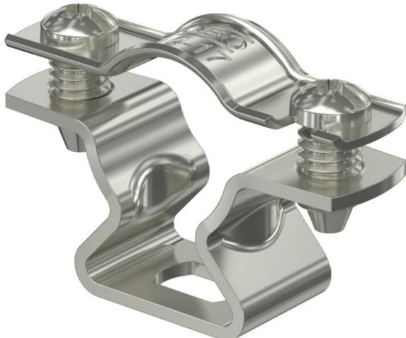
Collier d'écartement pour le montage de tubes et câbles au mur, au plafond et au sol. Avec couvercle autobloquant. Fixation par trou oblong. Autorisé pour la maintenance conformément à la norme DIN 4102, partie 12, classes de maintenance E 30 jusqu'à E 90.
