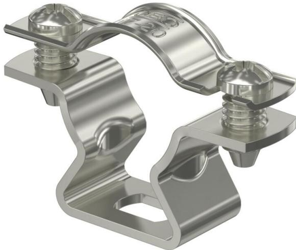
Collier d'écartement pour le montage de tubes et câbles au mur, au plafond et au sol. Avec couvercle autobloquant. Fixation par trou oblong. Autorisé pour la maintenance conformément à la norme DIN 4102, partie 12, classes de maintenance E 30 jusqu'à E 90.
