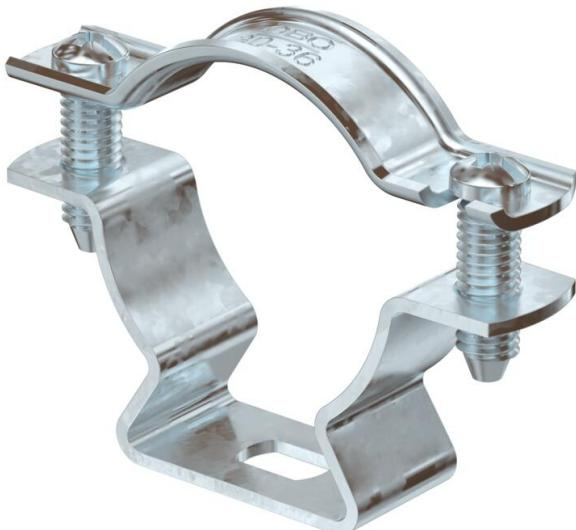
Collier d'écartement pour le montage de tubes et câbles au mur, au plafond et au sol. Avec couvercle autobloquant. Fixation par trou oblong. Autorisé pour la maintenance conformément à la norme DIN 4102, partie 12, classes de maintenance E 30 jusqu'à E 90.
