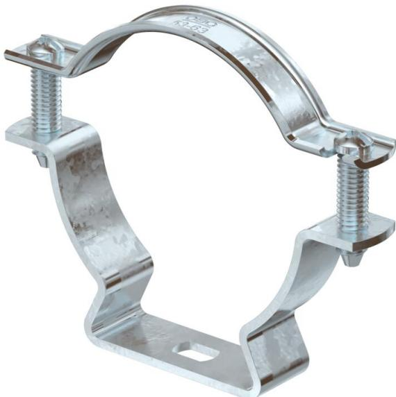
Collier d'écartement pour le montage de tubes et câbles au mur, au plafond et au sol. Avec couvercle autobloquant. Fixation par trou oblong. Autorisé pour la maintenance conformément à la norme DIN 4102, partie 12, classes de maintenance E 30 jusqu'à E 90.
