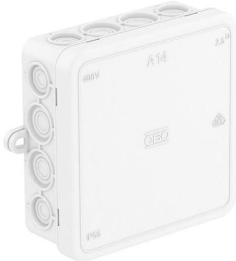
Indice de protection IP55, tension nominale 690 V, section nominale 2,5 mm<sup>2</sup>, 8 entrées pour diamètre de câble 5-14 mm
