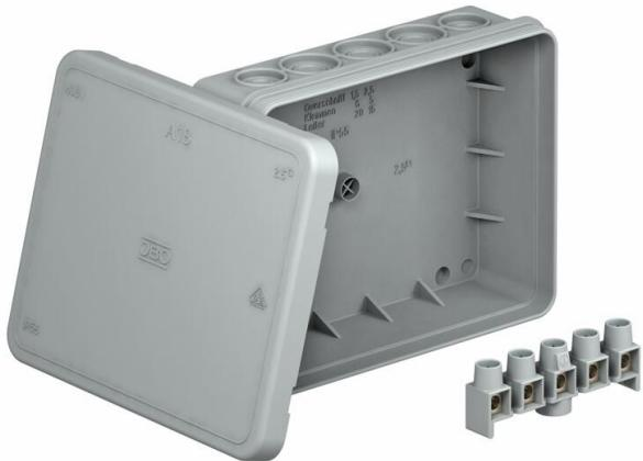
Indice de protection IP55, tension nominale 690 V, section nominale 2,5 mm<sup>2</sup>, 10 entrées pour diamètre de câble 5-14 mm
