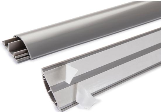
Passage de plancher pour la distribution encastrée des câbles au sol. Avec couvercle emboîtable et partie inférieure perforée au fond pour un montage direct au mur. Effectuer des changements de direction avec les pièces de forme et obturer les extrémités de goulotte à l'aide des embouts. Réservoir d'appareil pour le montage de systèmes électriques et de données.
