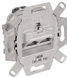
Boîtier de raccordement UAE Cat. 6 A ISO 8/8 avec anneau de support détachable pour version console. 2 raccordements. Remplit les exigences produit les plus hautes en matière de technique de transmission selon ISO/CEI 11 801:2011-06 pour largeur de bande de 500 MHz (10 Gb/s). Plaque centrale non comprise dans la livraison, doit être commandée séparément.
