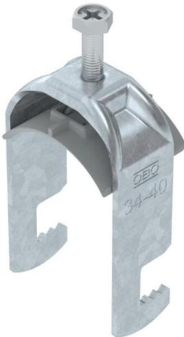
Bride de fixation avec pied F, plaque de pression en matière plastique en polypropylène. Pour montage vertical et horizontal d'1 câble individuel sur des fers plats. Avec vis à 1 filet sur plaque de pression, tête de vis hexagonale universelle SW10, avec fente et empreinte cruciforme. Convient au montage en intérieur et en extérieur. L'utilisation d'une contre-plaque est recommandée.
