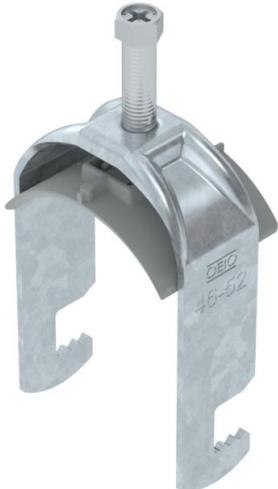
Bride de fixation avec pied F, plaque de pression en matière plastique en polypropylène. Pour montage vertical et horizontal d'1 câble individuel sur des fers plats. Avec vis à 1 filet sur plaque de pression, tête de vis hexagonale universelle SW10, avec fente et empreinte cruciforme. Convient au montage en intérieur et en extérieur. L'utilisation d'une contre-plaque est recommandée.
