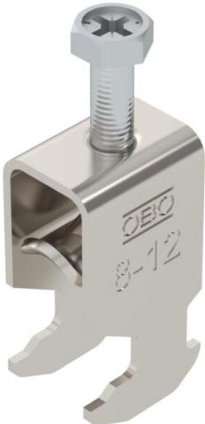
Bride de fixation avec pied H, plaque de pression en métal avec bords arrondis pour la protection des câbles. Pour montage vertical et horizontal d'1 câble individuel sur des rails profilés en C. Pour une ouverture de 16 – 17 mm. Avec vis à 1 filet sur plaque de pression, tête de vis hexagonale universelle SW10, avec fente et empreinte cruciforme. Convient au montage en intérieur et en extérieur. L'utilisation d'une contre-plaque est recommandée.
