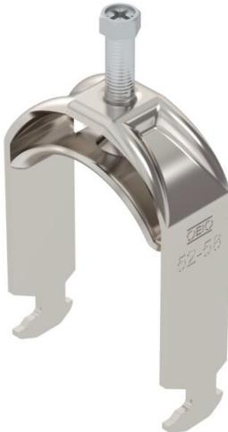
Bride de fixation avec pied H, plaque de pression en métal avec bords arrondis pour la protection des câbles. Pour montage vertical et horizontal d'1 câble individuel sur des rails profilés en C. Pour une ouverture de 16 – 17 mm. Avec vis à 1 filet sur plaque de pression, tête de vis hexagonale universelle SW10, avec fente et empreinte cruciforme. Convient au montage en intérieur et en extérieur. L'utilisation d'une contre-plaque est recommandée.
